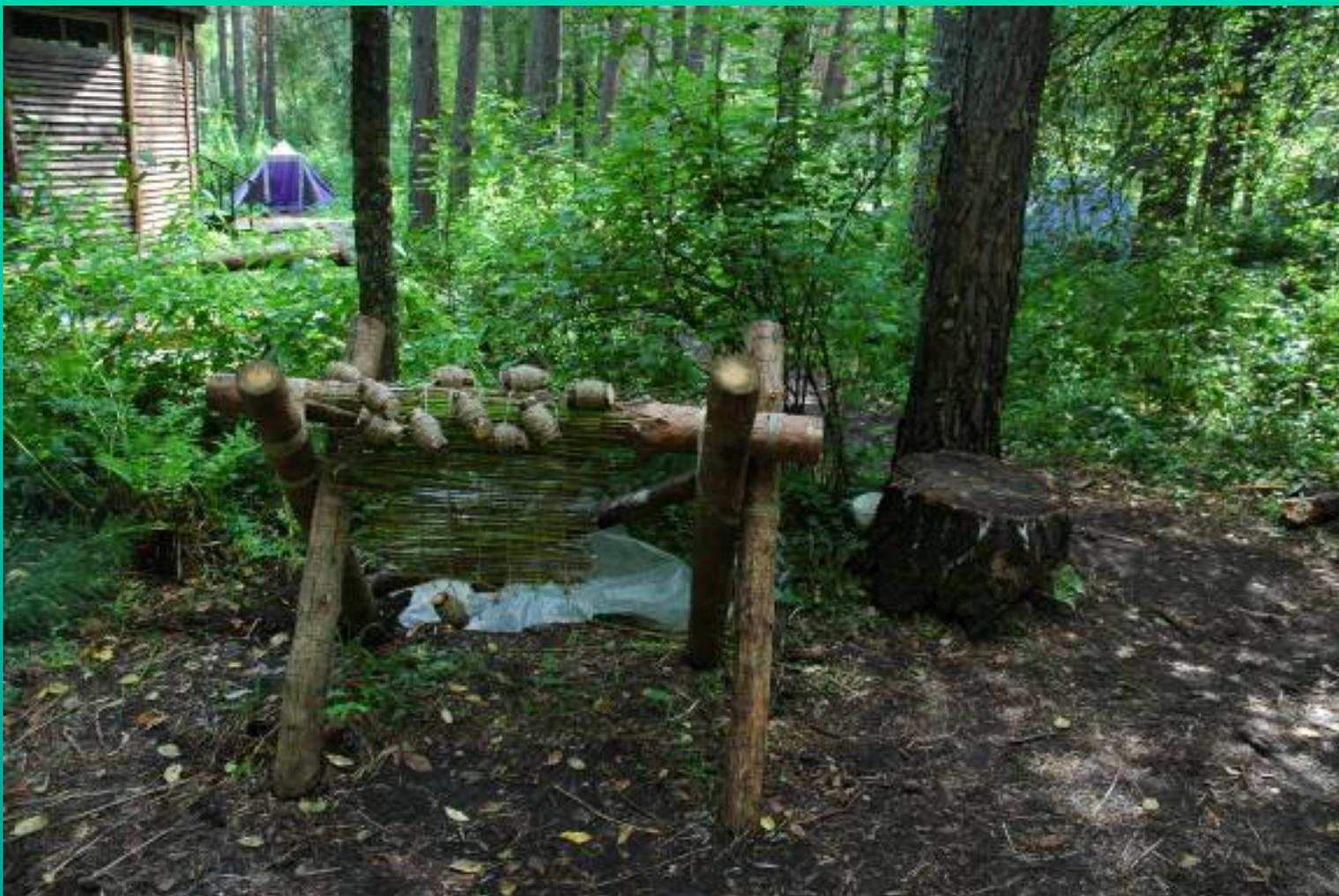
**Изготовлен станок для изготовления циновок.**
